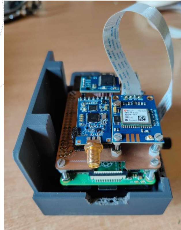
RPi 4, Câmera, Sensores (GPS e RTC), Modulo LoRa, PCB e HAT
